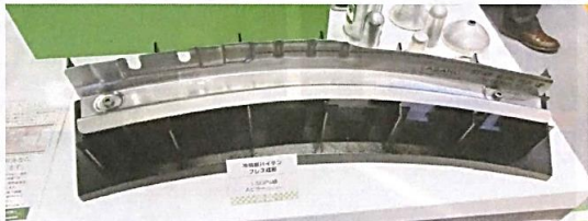
浅野、1.5GPa を活用した A ピラーの試作品
